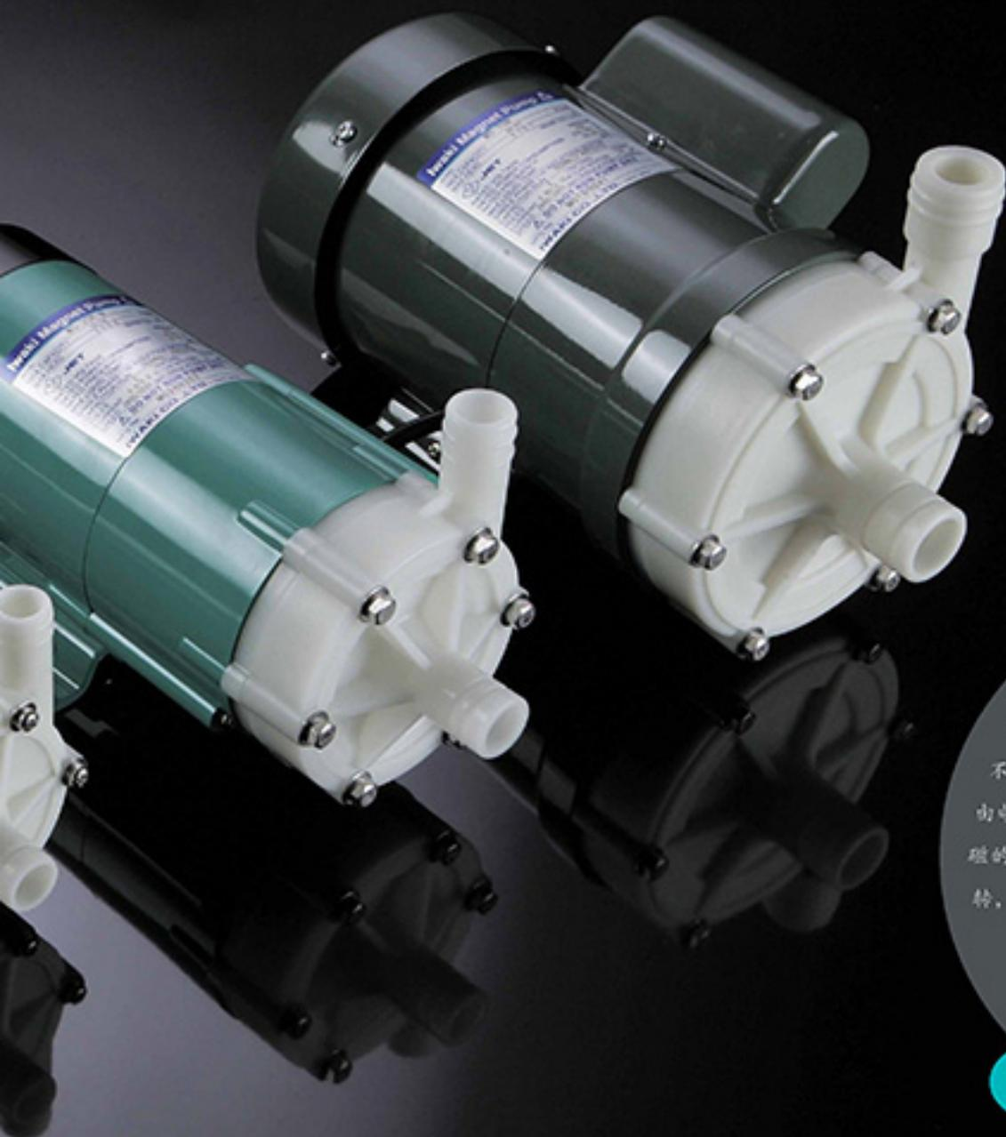
MD 系列磁力泵由一对连在叶轮和电机轴上的磁铁驱动。在结构上与传统离心泵不同，无轴封。泵腔被外壳隔开，由电机带动磁场旋转。主动磁和被动磁的耦合力矩带动叶轮旋转，从而实现液体输送。
